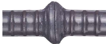
写真7.3 ふくらみの長さ不足
